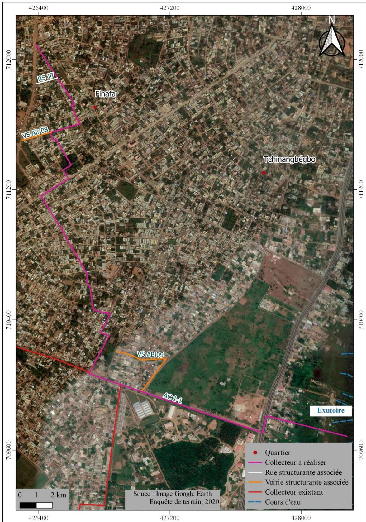
Figure 16 : Plan détaillés du collecteur AC1-1 à réaliser
